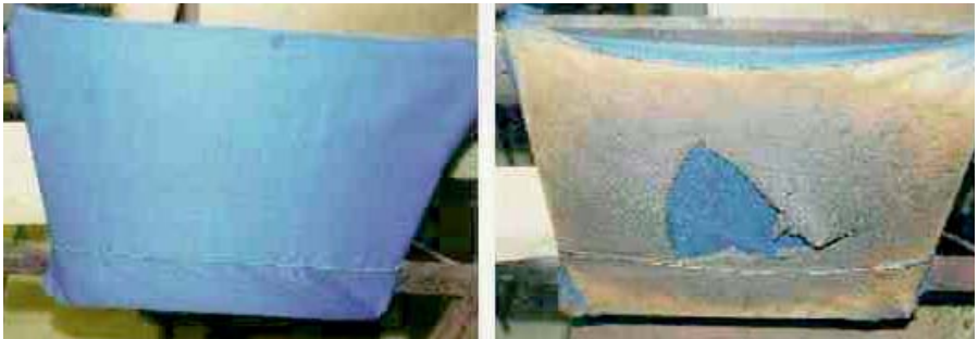
Prüfung 2 CENELEC I7 kA I0,5 s / Meta-Aramid, 2-lagig 420 g/m 2 Obere Lage zerstört / Kein Nachbrennen / Stoll-Kriterium überschritten
