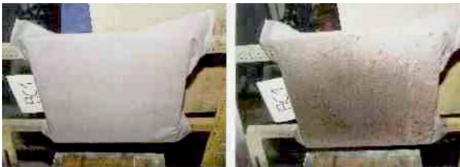
Prüfung 3 GENELEC/7 kA/0,5 s/Cotton FR, 2-lagig 650 g/m 2 Keine Lochbildung/Kein Nachbrennen/Stoll-Kriterium erfüllt
