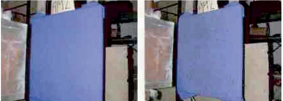
Prüfung 5 CENELEC/4 kA/0,5 s/Cotton FR, 2-lagig 650 g/m 2 Keine Lochbildung/Kein Nachbrennen/Stoll-Kriterium erfüllt
