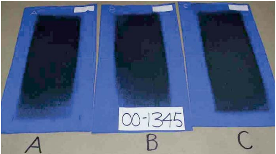
Prüfung 7.2 Prüfergebnis Schümer-SECAN® 100% Cotton FR, 330 g/m 2 , royal blue IEC/8 kA/0,17 s mit \bar{E}_i = 21,5 \text{ Ws/cm}^2
