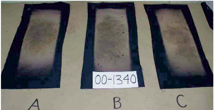
Prüfung 6.2 Prüfergebnis NOMEX® Delta A, 267 g/m 2 , navy IEC18 kAl0,15 s mit \bar{E}_i = 27,9 \text{ Ws/cm}^2
