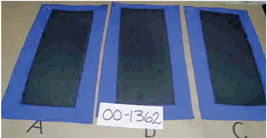
Prüfung 9.2 Prüfergebnis SECAN® FR, 100% Cotton, 511 g/m 2 , royal blue IEC18 kA/0,39 s mit \bar{E}_i = 73,01 \text{ W/s/cm}^2
