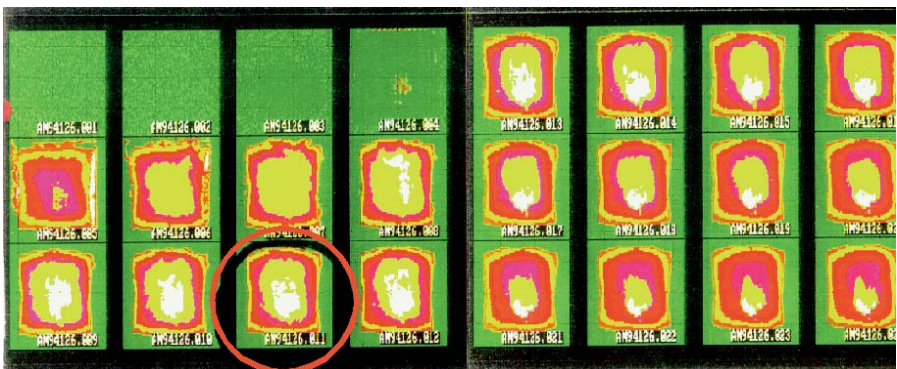
Bild 13 Thermographische Momentaufnahmen von Störlichtbogenprüfungen
