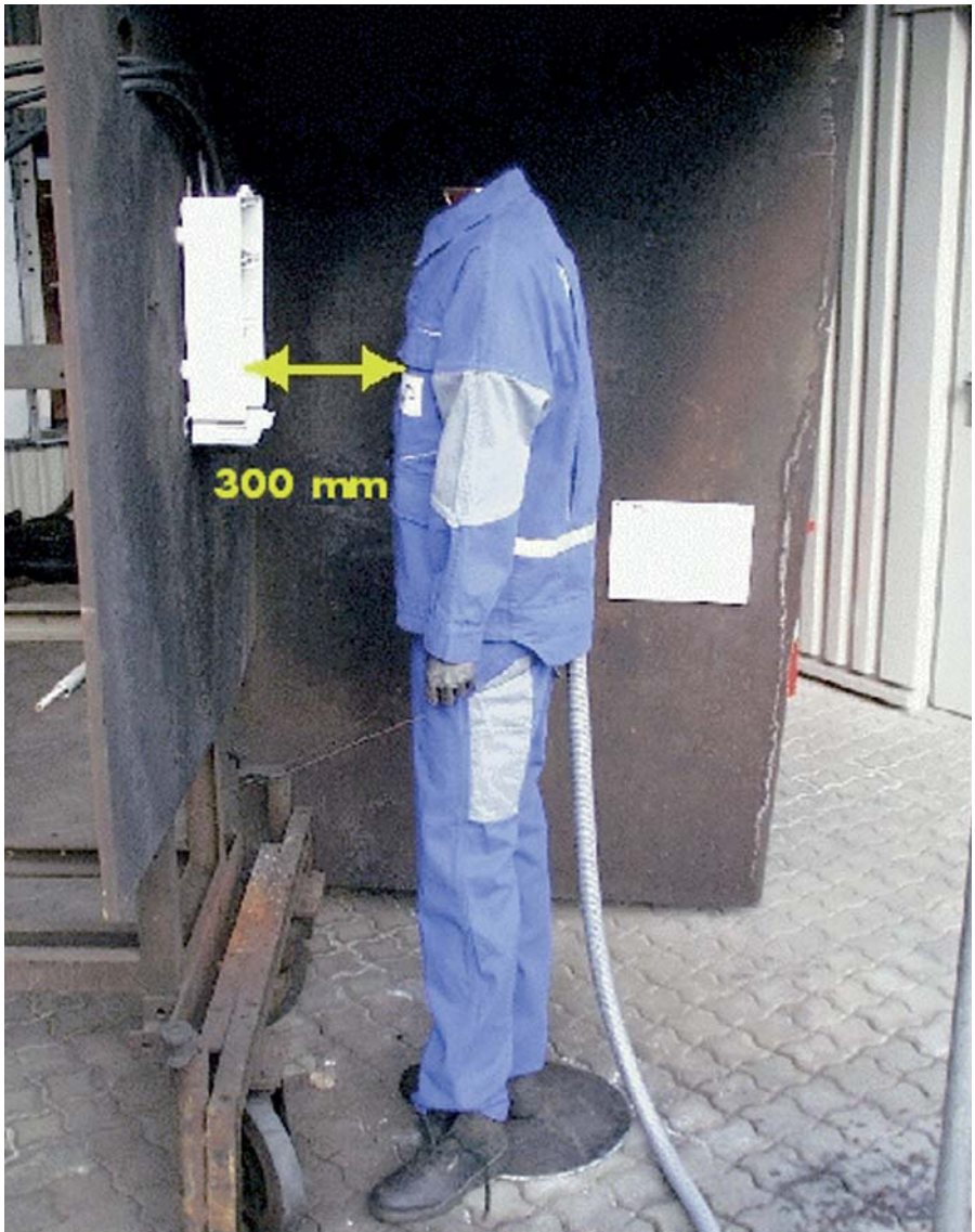
Bild 12 Hausanschlusskasten vom Typ KH 00100-2 und Schutzkleidung vor Störlichtbogenprüfung
