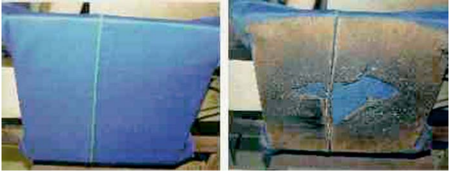
Prüfung 1 CENELEC I7 kA I0,5 s / Meta-Aramid, 3-lagig, 630 g/m 2 Obere Lage zerstört / Kein Nachbrennen / Stoll-Kriterium erfüllt
