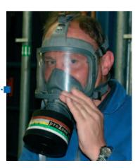
Filtergeräte mit einem batteriebetriebenen Gebläse und einer Haube oder Vollmaske als Atemanschluss haben einen deutlich verringerten Einatemwiderstand. Bei erhöhten Umgebungstemperaturen und längeren Arbeiten verbessert sich der Komfort für den Träger. Für die Sicherheit der Geräte ist, außer den Filtern, der Ladezustand der Batterien und der Volumenstrom wichtig.
