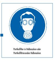
Partikelfilter schützen gegen Staub und Rauch. Gasfilter schützen gegen Gase und Dämpfe. Für welchen Gefahrstoff ein Filter geeignet ist geht aus seinem Kennbuchstaben und bei den Gasfiltern zusätzlich aus einer Kennfarbe (siehe BGR 190) hervor.
