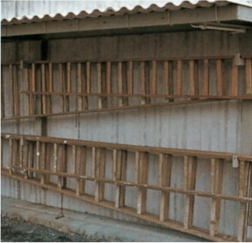
**Abb. 25: Leiterlager mit Steh- und Anlegeleitern verschiedener Größe. Verwenden Sie nur einwandfreie und damit sichere Leitern.**
