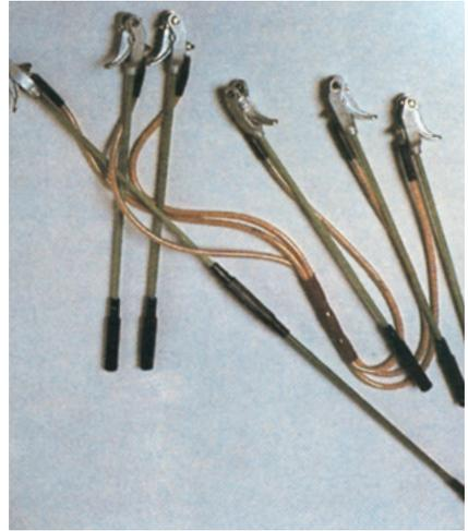
**Abb. 17:** Kurzschließvorrichtungen für Niederspannungs-Freileitungen
