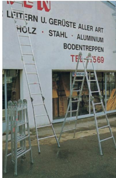
**Abb. 32:** Mehrzweckleiter zusammengeklappt, als Steh- und als Anlegeleiter
