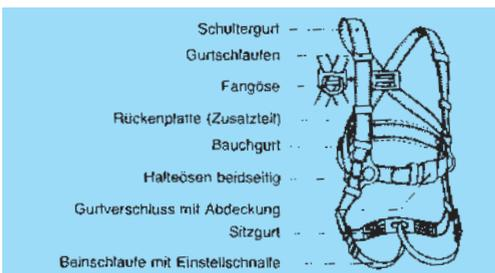
**Abb. 44: Auffanggurt mit rückseitiger Fangöse und seitlichen Halteösen**
