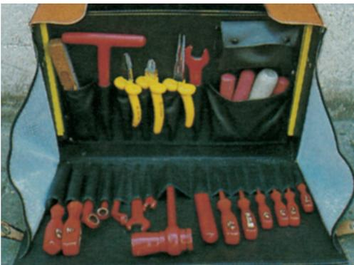
Abb. 18: Werkzeugtasche mit Isoliertem Werkzeug
