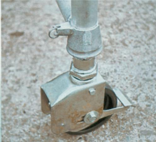
**Abb. 35:** Fahrrolle an einem fahrbaren Gerüst
