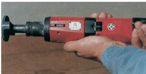
**Abb. 37: Bolzensetzwerkzeug mit PTB- und Prüfzeichen**
