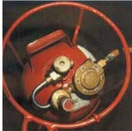
Bild 52: Flüssiggasflasche mit Leckgassicherung und aufgestecktem Schutzkorb
