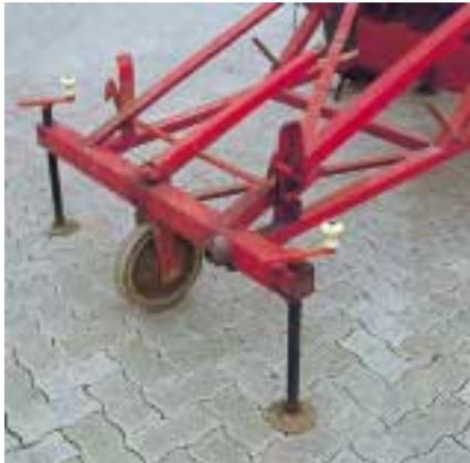
Bild 27: Richtig ausgefahrene Stützspindeln sind für die Stand-
