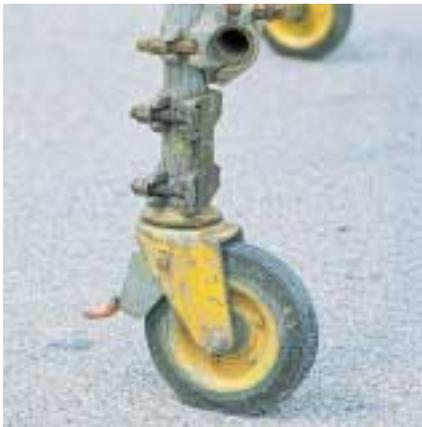
Bild 33: Fahrrolle mit Feststellvorrichtung
