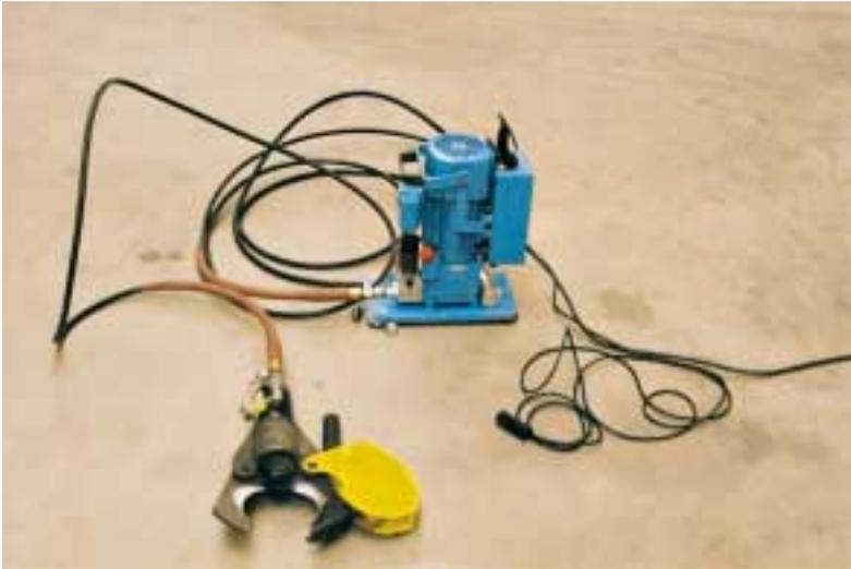
Bild 14: Hydraulische Kabelschneidvorrichtung mit Ansteuerung aus sicherer Entfernung
