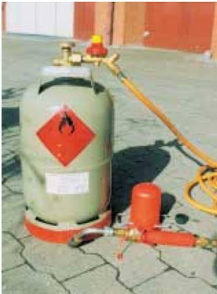
Bild 49: Flüssiggasflasche mit Verbrauchseinrichtung
