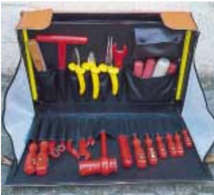
Bild 18: Besondere Werkzeugtasche mit isoliertem Werkzeug für Arbeiten an unter Spannung stehenden Teilen
