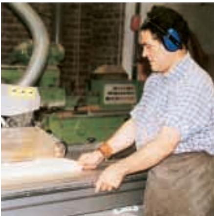
Abb. 1: Kreissäge, mit Gehörschutz arbeiten
