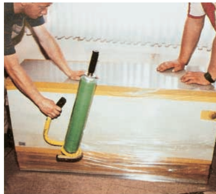
Abb. 2: Vollständiges Einpacken des Gerätes in reißfeste, antistatische Folie
