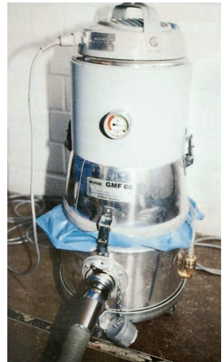
Abb. 3: Absaugen der Aufstellfläche des Gerätes mit einem geprüften Industrie-Staubsauger, Verwendungskategorie K 1
