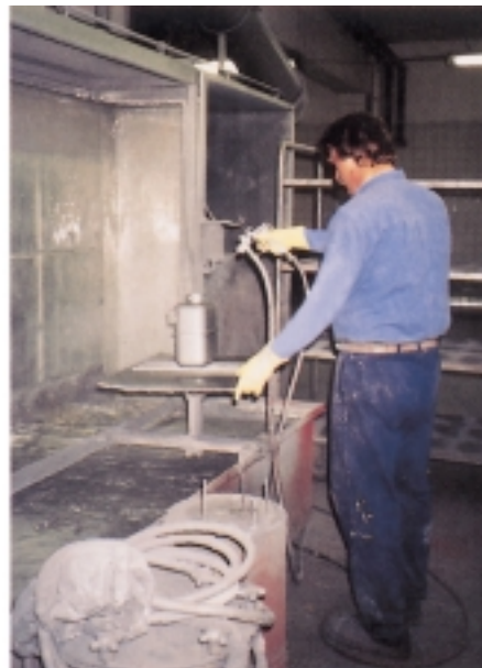
Abb. 2: Farbspritzen von Zählergehäusen
