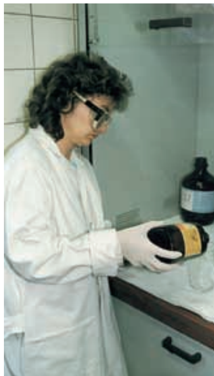
Abb. 2: Abfüllen von Aceton im Abzug
