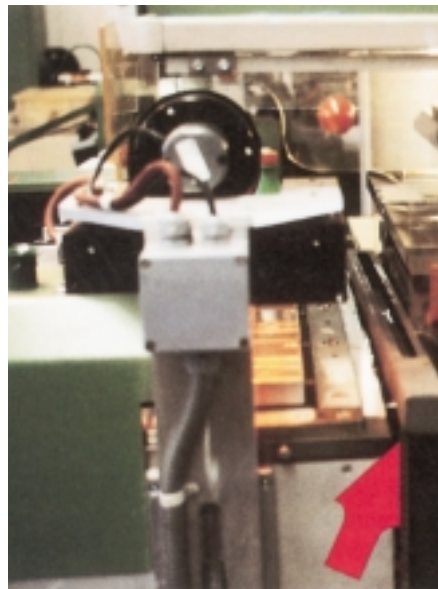
Abb. 2: Absaugschlitz an einer Tampondruckmaschine
