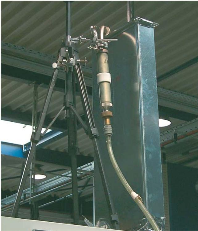
Abb. 8: IPS in der Reinluft hinter einem Abscheider
