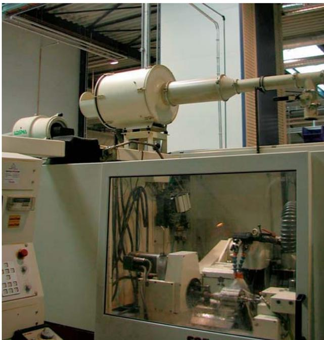
Abb.14: Maschine mit aufgesetztem Abscheider
