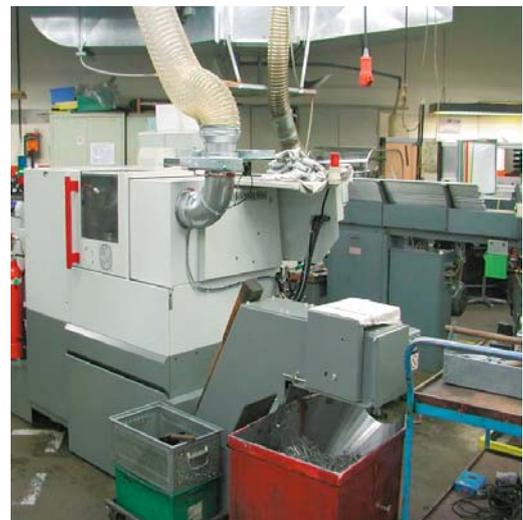
Abb. 18: Eingehauste Maschine mit Späneaustrag
