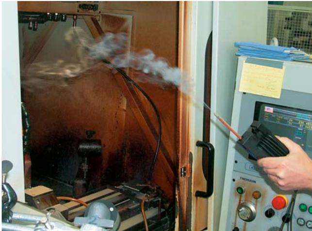
Abb. 23: Einregulierung des Abluftvolumenstromes mit Strömungsprüfröhrchen
