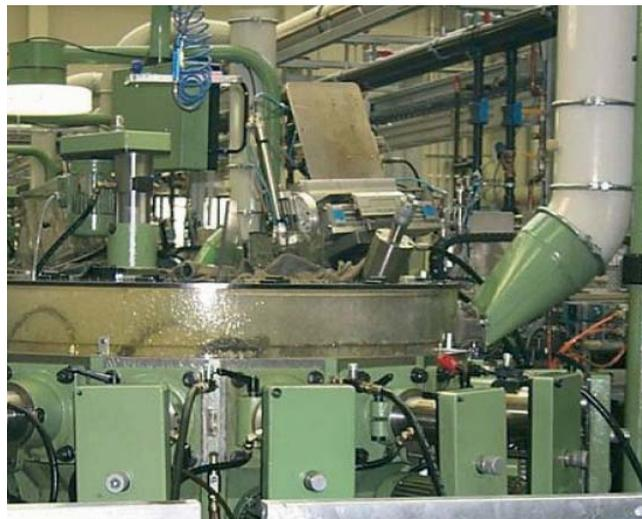
Abb. 21: Maschinenabsaugung
