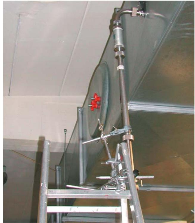
Abb. 9: IPS in der Abluft einer RLT-Anlage
