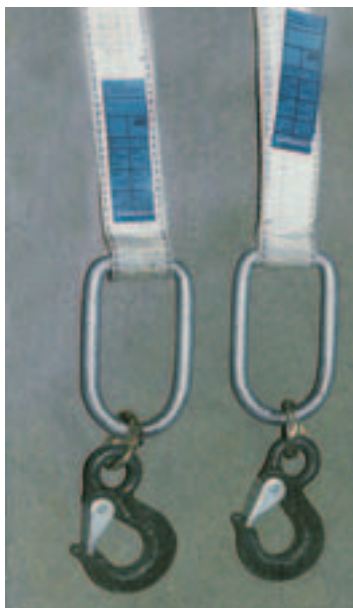
Hebeband mit Lasthaken und Hakensicherung
