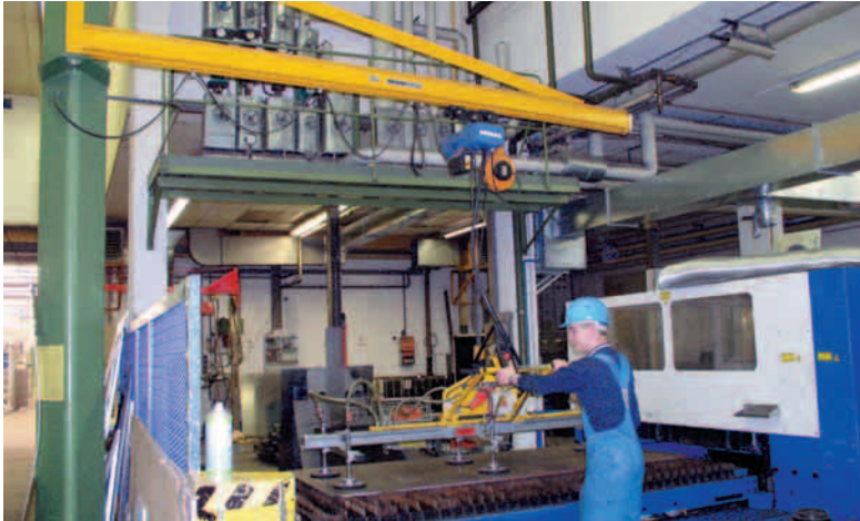
Abb. 49: Säulenschwenkkran mit speziellem Lastaufnahmemittel
