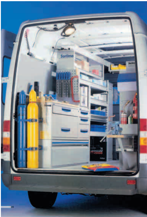
Abb. 63: Beispielhafte Ladungssicherung in einem Kastenwagen
