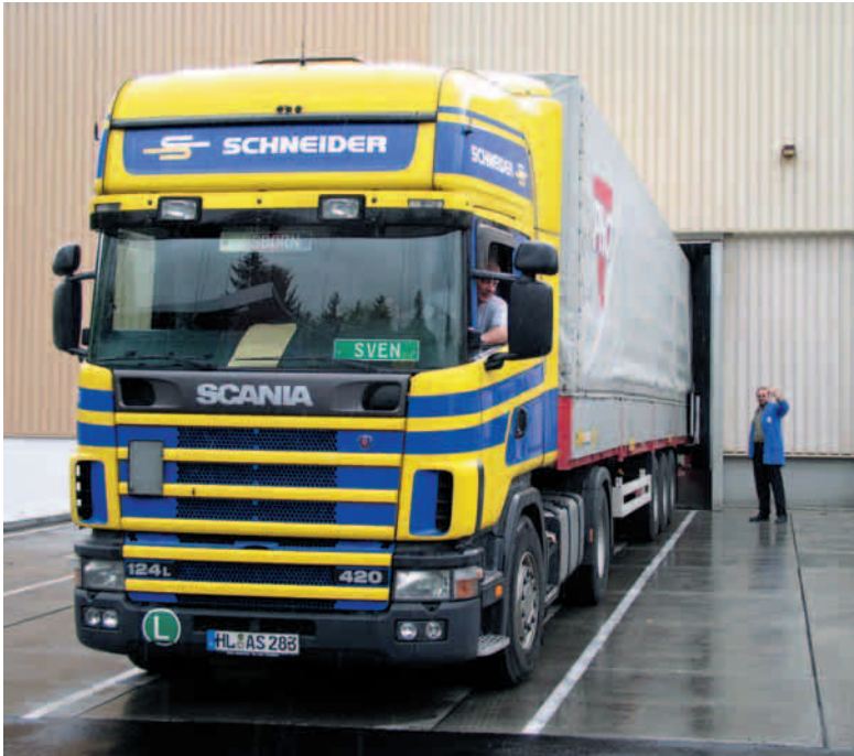
Abb. 59: Einweiser beim Rückwärtsfahren
