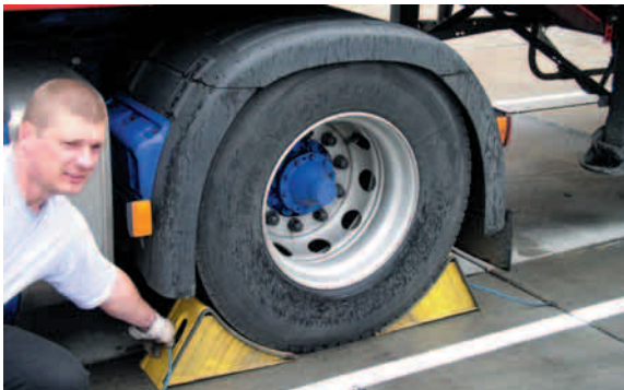
Abb. 58: Sicherung des Fahrzeuges mittels Unterleg- keilen am Rad
