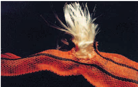
Abb. 73: Durch Schnitte beschädigte Umhüllung und Einlage
