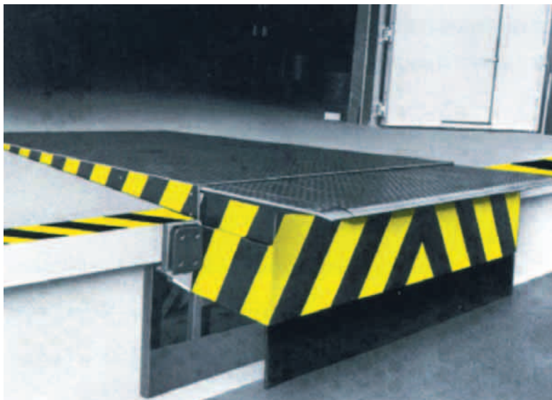
Abb. 77: Sicherung von Quetsch- und Scherstellen. Abdeckbleche sichern die Quetsch- und Scherstellen an den Seiten der Ladebrücke. An der Vorderseite (Hofraumseite) sichert eine Gummischürze gegen den Zugriff zum Gefahrenbereich unter der Ladebrücke. Gefahrenkennzeichnung nach BGV A8
