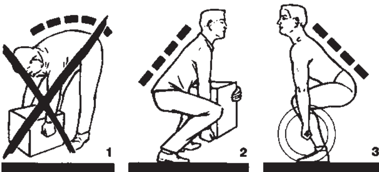
Abb. 21: Richtiges Heben von Lasten
