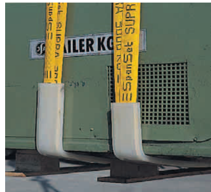
Abb. 71: Schutzschlauch als Schutz vor scharfer Kante
