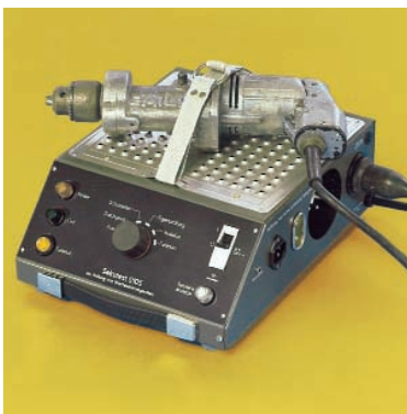
Abb. 25: Prüfung eines Elektrowerkzeuges auf elektrische Sicherheit und Funktion
