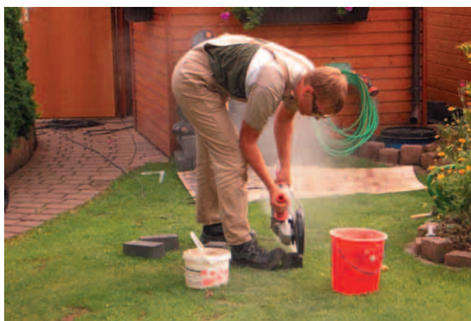
Bild 25: Einsatz handgeführter elektrischer Betriebsmittel unter besonderen Umgebungsbedingungen; z. B. Nässe oder leitfähiger Staub
